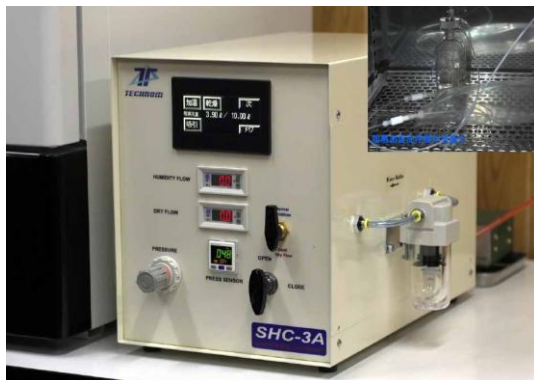
加熱加湿洗浄法によるサンプリングバッグ洗浄装置（(株) テクロム製）
