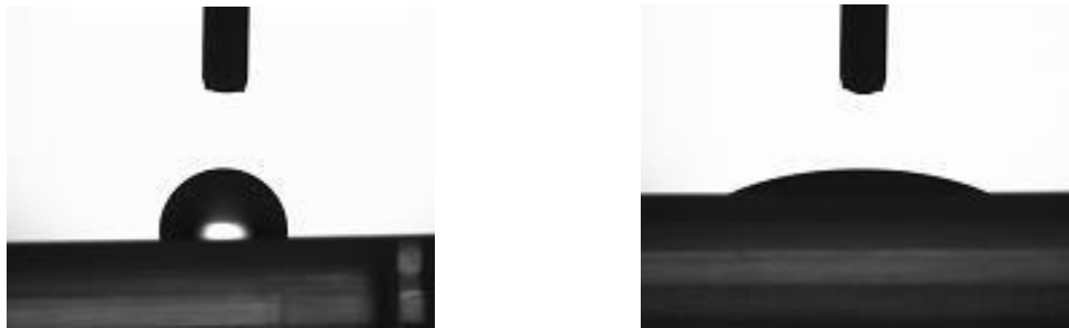
図 親水化処理前後の樹脂表面の接触角測定（左：処理前 右：処理後）
